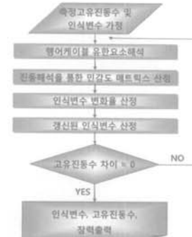
그림 7. 시스템인식 기법을 이용한 장력추정 방법 개략도
