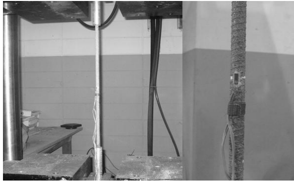
〈그림 4〉 AFRP 보강근의 인장시험 실험설정
