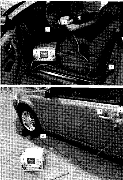
[그림 10] 차량의 정전기 인가 포인트 및 장비 셋업
