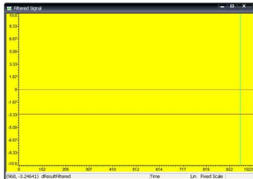
그림 3-8 FIR 필터 적용후의 입력 파형(Cutoff = 0.1Hz)
