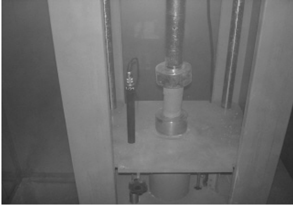
그림 6. 일축압축시험기(냉동챔버 내부에 설치)
