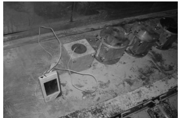
그림 8. 공시체 내부 온도 측정
