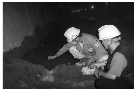
그림 7. 경부고속철도 OO-O공구 V-notch 설치 전경 및 수위측정 전경
