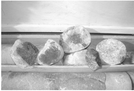
그림 9. 육안관찰에 의한 주입재 침투성확인(경부고속철도 00-0공구)
