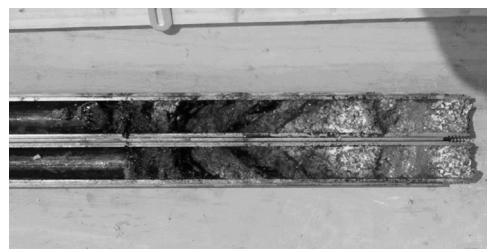
그림 8. 육안관찰에 의한 주입재 침투성 확인(지하철 OO공구)
