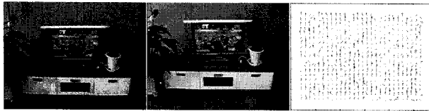
그림 12. 위쪽 수직이동 움직임과 광류 Fig. 12. Upward translation and optical flow.
