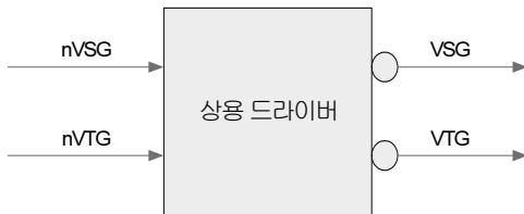
그림 14. 수직방향 서밍클럭 및 전달클럭 드라이버
