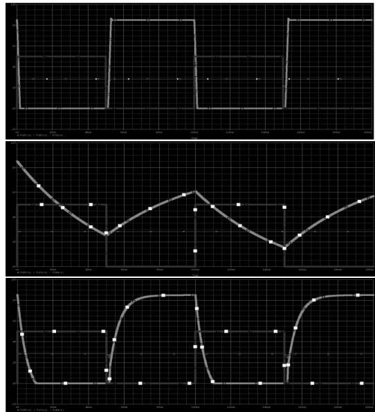
그림 13. C3 커패시터에 따른 증폭기 출력신호 변화(상-No capacitor, 중-2..2nF 하-220pF)
