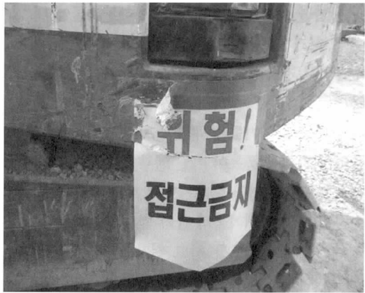
이동식크레인 후면부(강재거푸집과 접촉된 흔적)
