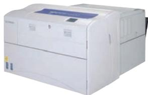
화사에 설치된 탄토6120은 외장형 드럼 방식의 CTF로 필름, 인쇄지, 실버 플레이트 등의 다양한 미디어에 이용할 수 있으며, B1사이즈에서 최소 A2사이즈까지 6종류의 사이즈가 가능하다. 120채널의 LED광원을 탑재했으며, 최대 노광 사이즈는 810×1120mm, 최대 해상도는 400dpi이다.
