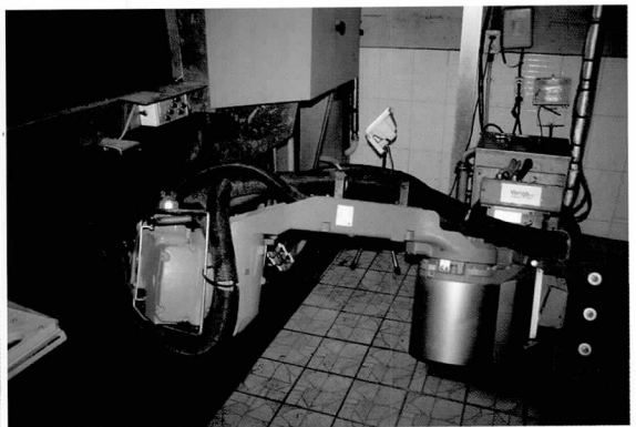
과거 하루 3회 파이프라인착유 하던 대원목장은 2006년 11월 로봇착유기를 설치하였다. 중앙의 로봇팔이 좌우로 움직여 2개의 착유틀을 관리한다. 기계 오작동의 발생시 즉각 수리하지 못하면 손해다. 로봇착유기 목장에서의 생산유량은 곧 착유횟수에 달려기 때문이다. 대원 목장에는 보통 1시간동안 10~12두의 착유우가 착유실을 들락거린다고 한다.
