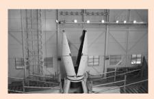
단부는 2단 킥모터, 관성항법유도시스템, 전자탑재시스템, 제어시스템, 비행안전시스템, 노즈페어링 등순수 국내 기술로 개발된 핵심 구성품들로 구성되어 있다. 이러한 상단부의 핵심 구성품들을 국내 자력으로 설계, 제작, 시험/평가 및 조립을 성공적으로수행함으로써 우주발사체의 핵심기술들을 확보하게됐으며, 이러한 기술들은 향후 한국형 우주발사체개발에 직접 활용될 것이다.
