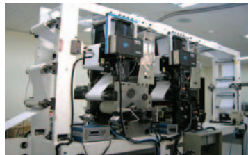
그림 5. PEMS 소자 생산용 롤투롤 프린팅 공정 장비
