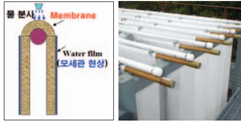
그림 3. 멤브레인을 집진판으로 이용한 습식 전기집진기
