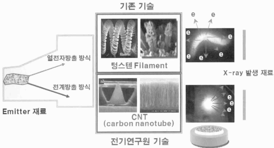
그림 5. 탄소나노튜브 전자방출원과 기존 텅스텐 필라멘트 전자방출원 비교
