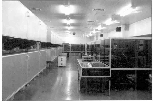
그림 2. 한국원자력연구원이 구축한 국내 최대 규모의 1 kJ 고에너지레이저 시설. 7단 증폭된 레이저에서 4개 빔라인을 동시에 제공할 수 있으며, 다양한 실험을 위해 임의파형 발진기, 초단펄스 발진기 등을 준비 중에 있다.
