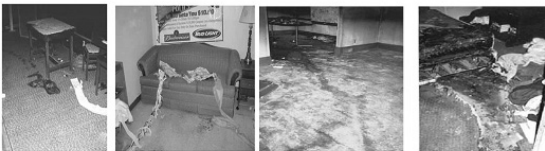
【사진 6.1, 6.2】 두루마리화장지에 시너를 뿌려서 방화한 트레일러 패턴
