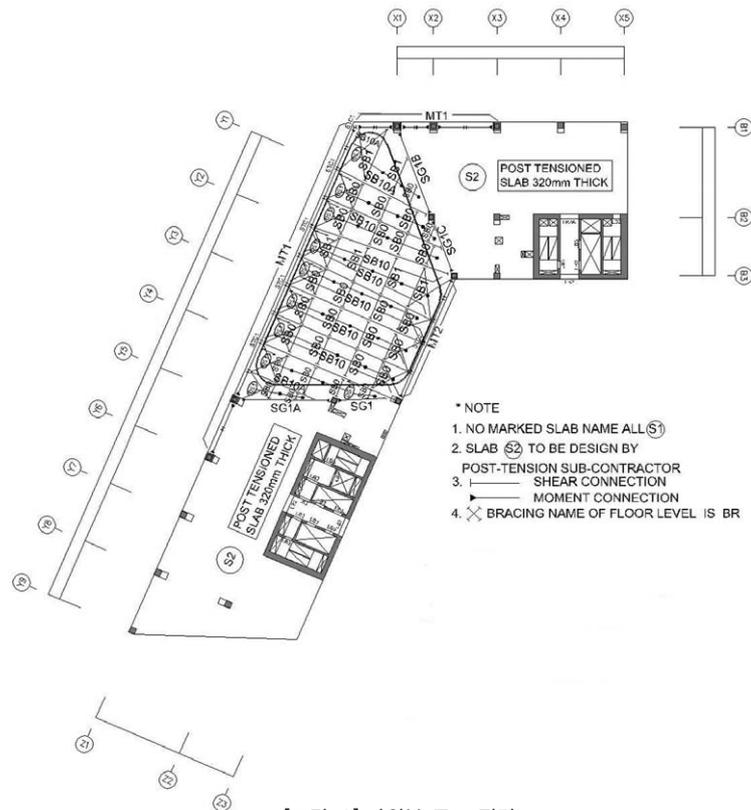
[그림 4] 타워부 구조 평면도
