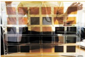
한국전기연구원 광전기연구그룹 이동윤 박사팀은 모듈 최대 효율 6%, 서브모듈 크기가 10cm×10cm인 탄소나노튜브 상대전극을 이용한 염료감응형 태양전지를 개발하는데 성공했다고 밝혔다. 탄소나노튜브를 이용한 염료감응형 태양전지는 고가의 백금에 비해 가격이 저렴하고 화학적 안정성이 뛰어나면서 촉매특성이 우수한 탄소나노튜브를 사용해 제작비용을 크게 낮출 수 있다.
