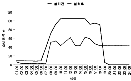
Fig 4. 분리형 PC와 프린터의 세이버 설치 전·후 소비전력 변화.
