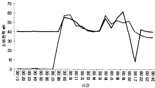
Fig 3. 일체형 PC와 프린터의 세이버 설치 전·후 소비전력 변화.
