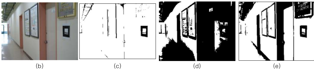
<그림 4> 고정 및 적응적 임계치 방법을 사용한 이진화 영상들. (a) 영상(a)의 히스토그램과 혼합가우시안확률분포, (b)원 영상, (c)-(e) 고정 및 적응적 임계치 방법에 의한 이진화 영상( \theta=70, 150, 112 )
