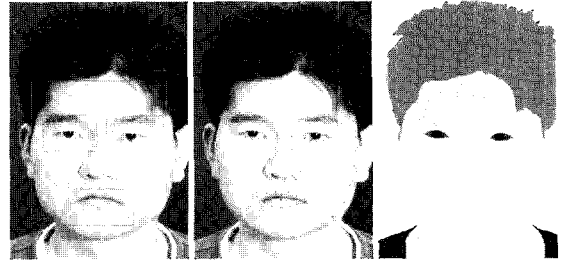
그림 1: 얼굴 인식 및 세그멘테이션 결과. 왼쪽: Haar-like 특징 검출 결과, 가운데: AAM 결과, 오른쪽: 세그멘테이션 결과
