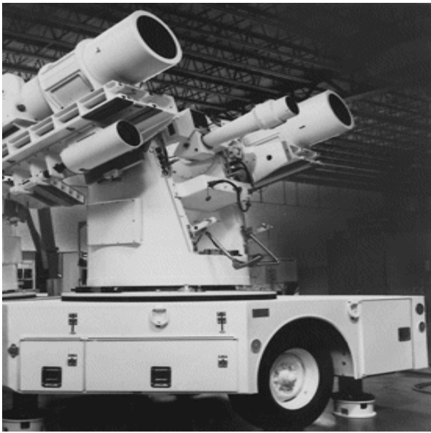
자료 : 참고문헌 [9] 그림 10. KINETO 433 광학 추적 장비 (BrashearIps사)
