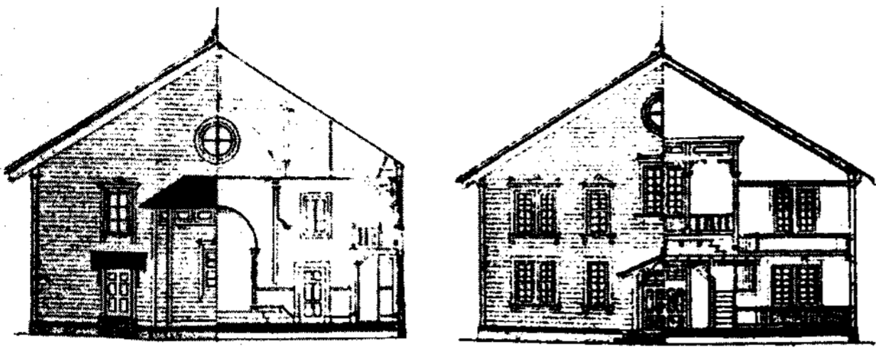
그림 9. 「체조유희 취조보고(體操遊戯取調報告)」(1905년)에 제시되어 있는 옥내체조장 겸 강당의 가상 설계도 (출처:菅野誠 외, 『日本の學校建築：發祥から現代まで』, 文教ニュース社, p484, 1983)
