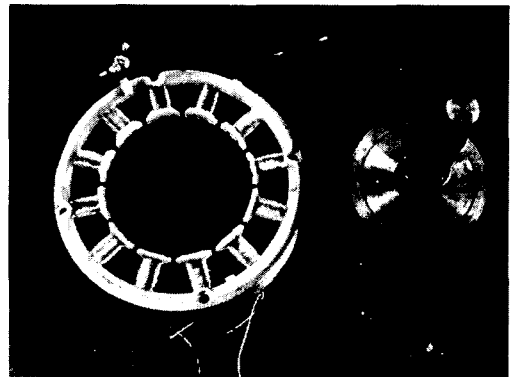
그림 28. 설계된 희토류 자석 BLDC 전동기 Fig. 28. Designed rare earth magnet BLDC motor
