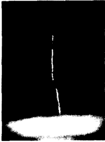
그림 7. 순수 XLPE 시료의 단시간 절연파괴 흔적 Fig. 7. Breakdown mark of pure XLPE specimen
