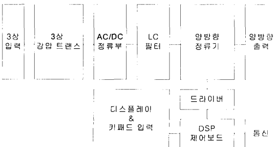
그림 3. 정류기 시스템의 구성 블록도
