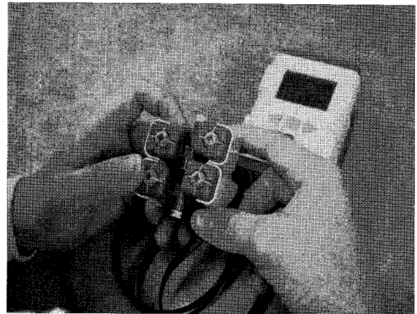
(그림 5) 4개의 터치 센서를 이용한 점자 입력기
