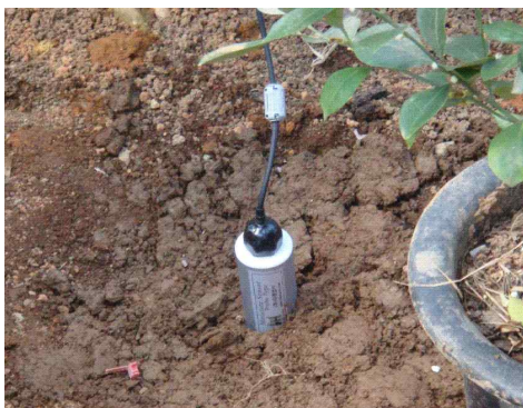
그림 7. EC 센서의 설치 형상 Fig. 7. Establishment form of EC sensor.
