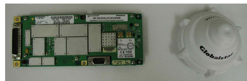
그림 11. 글로벌스타 위성 모뎀 및 안테나 Fig. 11. Globalstar satellite modem and antenna
