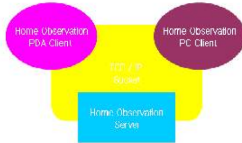
그림 3. Home Observation의 시스템 구조 Fig. 3. Structure of Home Observation
