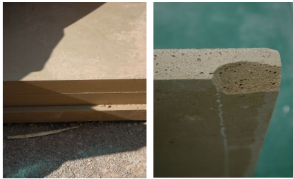
그림 1. 인조목재 입면 그림 2. 인조목재 단면
