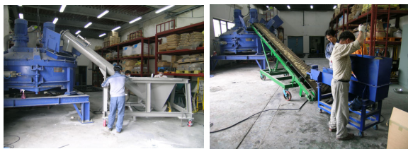
그림 8. 이동식 스크류 컨베이어를 이용한 재료 투입
