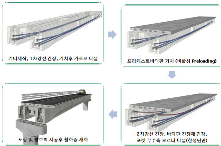
그림 3. PnP 거더 시스템을 이용한 단순교 시공
