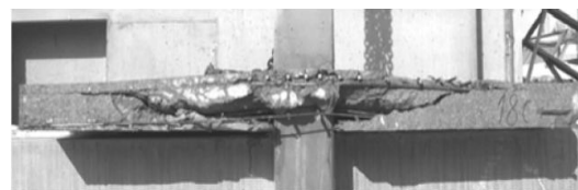
그림 10. 전단 스테드로 보강된 시험체 18c의 최종실험 종료 후 절단면도
