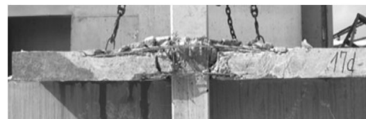
그림 11. 연성철물로 보강된 시험체 17d의 최종실험 종료 후 절단면도
