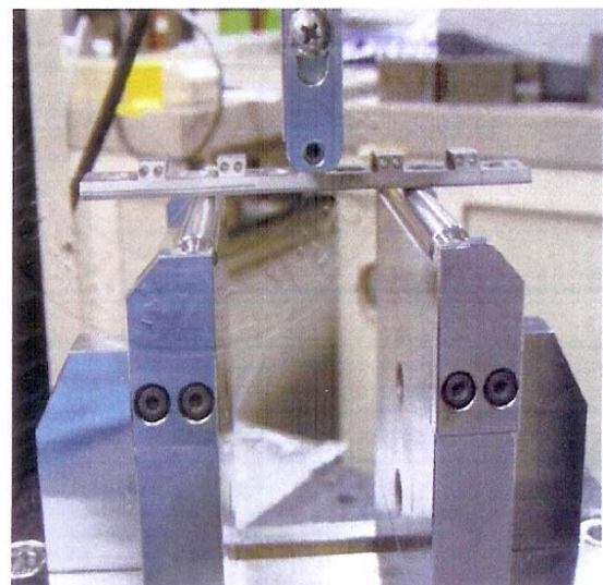
그림 4. ISO 9585-1990 4점 굴곡 시험 장비
