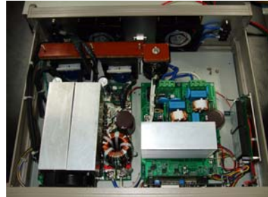
그림 9 실험에 적용된 제안된 방식의 3[kW]급 직렬형 DC/DC 컨버터 Fig. 9 Proposed 3[kW] series DC/DC converter for experiments
