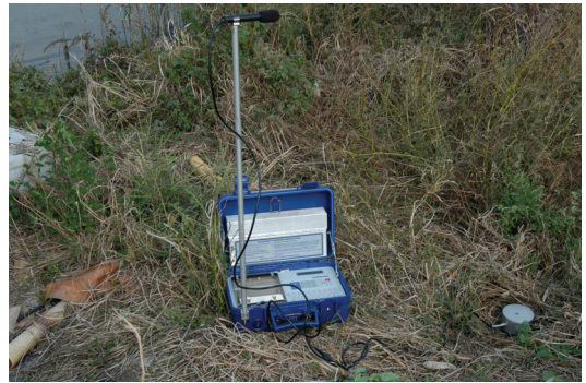
Fig. 3 Geo-Phone과 Micro-Phone이 연결된 Blastmate III
