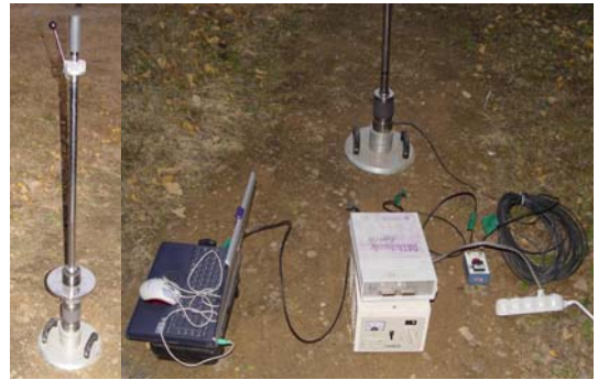
Fig. 2 노상에서의 소형 FWD 시험전경
