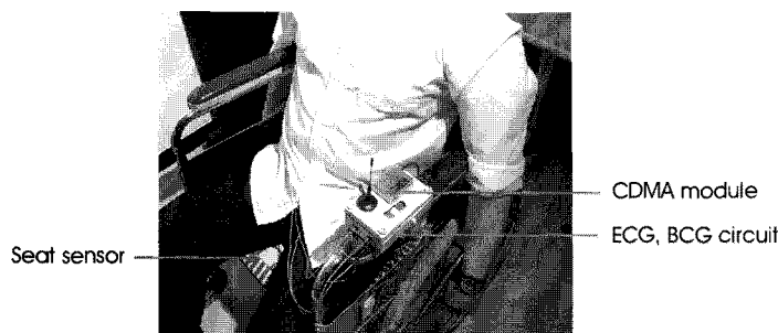
그림 2. 휠체어용 생체신호 전송장치 Fig. 2. Developed device on wheelchair
