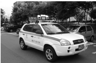
〈그림 2〉 단속장비의 효율화 : 이동식 CCTV(자동형)를 탑재한 단속차량(계양구)
