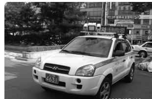
〈그림 2〉 단속장비의 효율화 : 이동식 CCTV(자동형)를 탑재한 단속차량(계양구)
