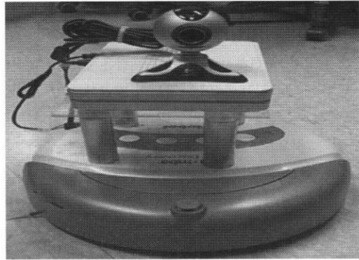
그림 14. 구현된 홈 모니터링 시스템 Fig 14. home monitoring system of implementation
