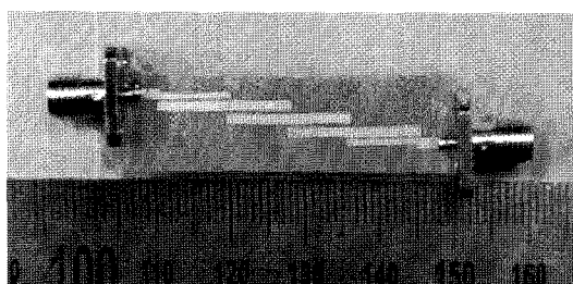
(a) 평행결합 구조의 대역통과 여파기 (a) Conventional BPF with parallel coupled line
