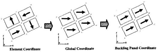
으로 수정하여 각각의 좌굴 Panel에 대해서는 좌굴 Panel 좌표계 상의 응력이 필요하다. 본 시스템에서는 좌굴 Panel 상의 좌표계로 응력을 자동적으로 변환하여 계산을 수행한다.
