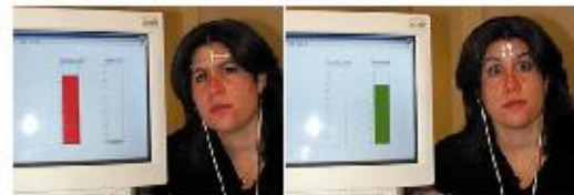
분란감(red) 또는 흥미로움(green) 표현을 감지하는 센서
