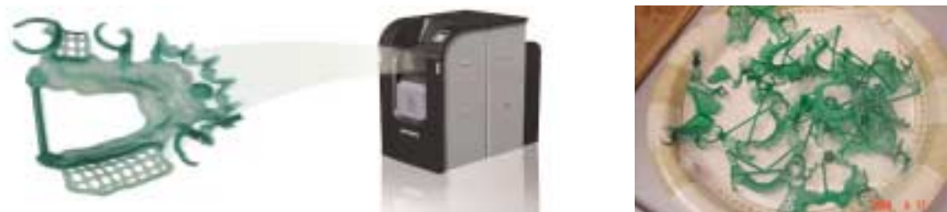
그림 14 RP 프린터에 의해 출력된 레진 framework
