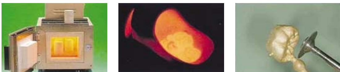
그림 16 Lost Wax technique의 소환 및 주조와 연마과정
