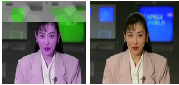
(A) 일반적인 멀티캐스트 환경에서 수신한 동영상 화면 (B) 자원관리를 통해 QoS를 제공하는 멀티캐스트 환경에서 수신한 동영상 화면
