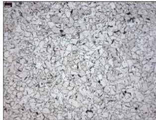
그림 8. 타워 플랜지 소재의 광학 현미경 사진 (S355NL steel)
