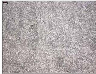
그림 5. 로터 회전축 소재의 광학 현미경 사진 (34CrNiMo6 steel)
