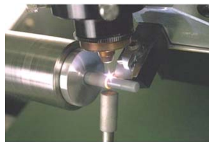
그림 6. 레이저 예열을 통한 세라믹의 선삭작업 (Purdue Univ.)
