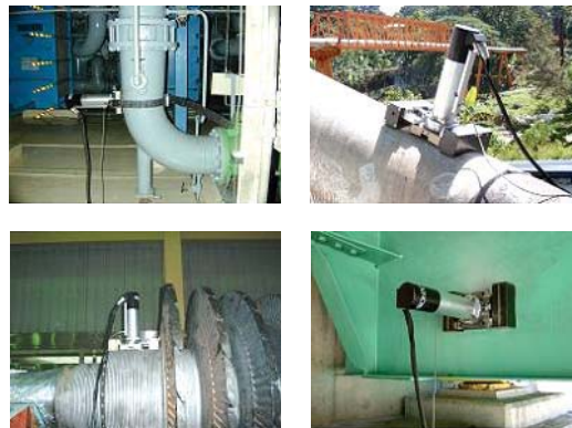
그림 2. 계장화 압입시험기의 산업 현장 및 발전설비 사용 예
